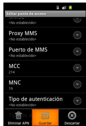
En MMC introducimos el valor "214" y en MNC "19". Precionamos la tecla MENU y elegimos GUARDAR
